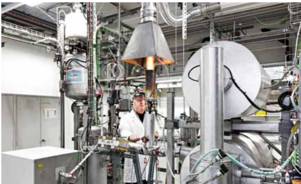
Les chercheurs de l'Institut Paul Scherrer PSI utilisent cette installation de laboratoire pour extraire d'une matière première naturelle, le bois, du gaz riche en énergie : le processus transforme le bois en un gaz synthétique qu'il est possible d'injecter dans les conduites publiques. L'énergie fournie par le bois est ainsi utilisable pour produire de l'électricité dans des centrales à gaz ou pour la propulsion de véhicules. L'énergie qui est exploitée est très respectueuse de l'environnement, car la gazéification du bois est neutre du point de vue du CO 2 . (Scanderbeg Sauer Photography)
