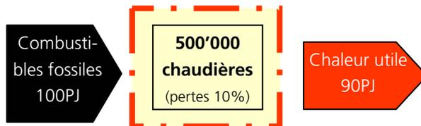
**Fig. 1: Flux d'énergie des chaudières à combustible fossile**
