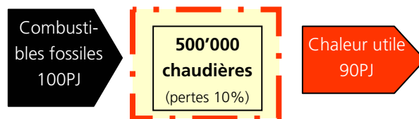
Fig. 5: Flux d'énergie des chaudières à combustible fossile
