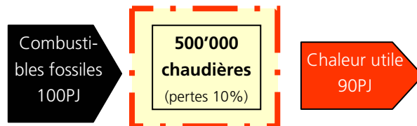
Fig. 1: Flux d'énergie des chaudières à combustible fossile
