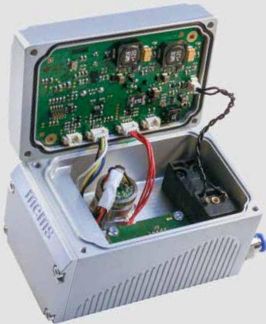
**Capteur de qualité du gaz de l'entreprise MEMS AG analysant la composition du gaz en temps réel, afin de régler correctement les paramètres de combustion dans un moteur à gaz.**
