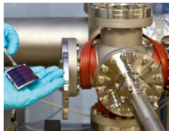
L'Empa fait partie des laboratoires de pointe à travers le monde dans le domaine des cellules photovoltaïques en couches minces CIGS. Depuis 1999, le degré d'efficacité a passé d'environ 13 % à plus de 20 % au cours des différentes étapes de développement, et chaque étape représente un record mondial.
