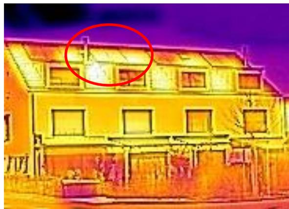
**Schéma 6:** thermographie de quatre groupes de capteurs solaires à l'aide du système FLIR C2, le 14/04/2015, à Reinach (BL). Le deuxième groupe de capteurs de gauche est en surchauffe, puisqu'il présente la même température que le toit. Si l'énergie solaire était correctement transmise, le capteur apparaîtrait d'une couleur plus sombre que le toit.
