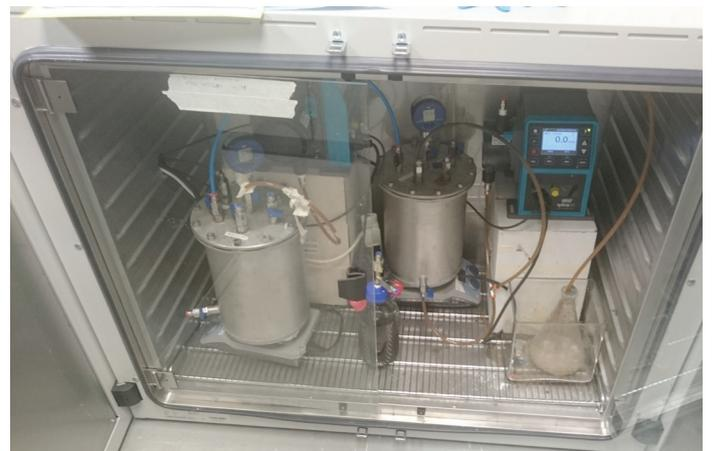
Dans le cadre d'un projet, Roger König de la Haute école spécialisée de la Suisse italienne, a examiné la fermentation anaérobie biphasique des biodéchets industriels pour la production de biogaz. Sur l'image: un incubateur qui maintient les réacteurs à une température constante de 36 °C. Photo: SUPSI
