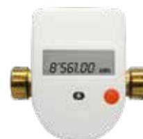
Les compteurs de chaleur présentent des tolérances de mesure pour le capteur de volume, les capteurs de température et le calculateur. Les erreurs maximales du calculateur et du capteur se montent à 1% environ. L'erreur principale vient du capteur de volume qui peut se monter à 5% au maximum. Les écarts atteignent en moyenne 3% pour les compteurs de chaleur.
