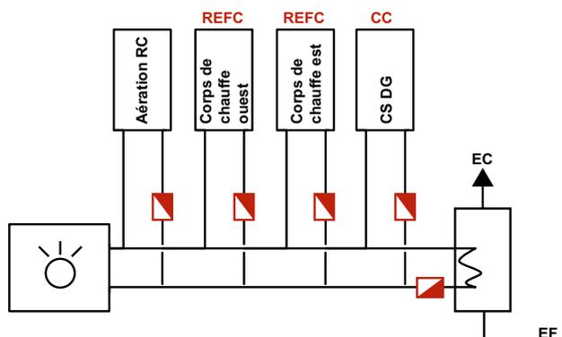
En cas de raccordements de nouveaux circuits de chauffage sur une distribution de chaleur existante, le groupe de consommation et le sous-groupe doivent être munis d'un compteur de chaleur pour que les différents systèmes de mesure puissent être pris en compte par des calculs de différence.
