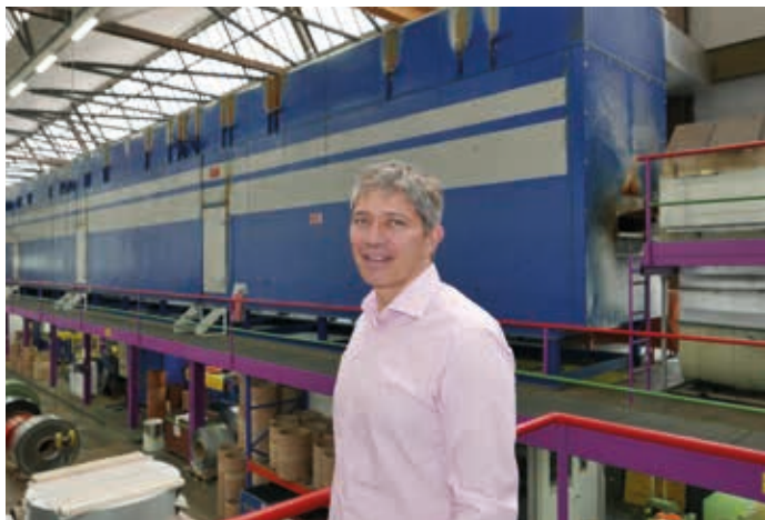
Markus Reber, le directeur de Metal Paint SA devant le four de cuisson de Metal Paint. Les rejets de chaleur de la postcombustion chauffent aujourd'hui l'air d'alimentation du four de cuisson à 240 °C.
