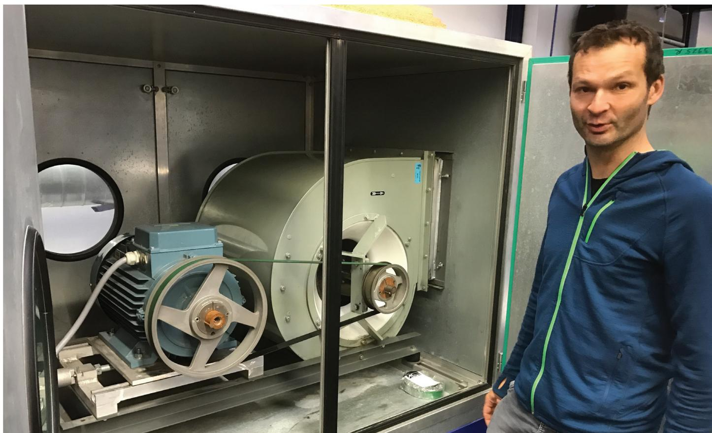
Le chercheur HSLU Christoph Dahinden avec un ventilateur d'aération dans le laboratoire de recherche du centre de technique intégrée du bâtiment de Horw à Lucerne. L'énergie de transmission du moteur électrique est transmise au ventilateur par le biais d'une courroie trapézoïdale. Photo : B. Vogel
