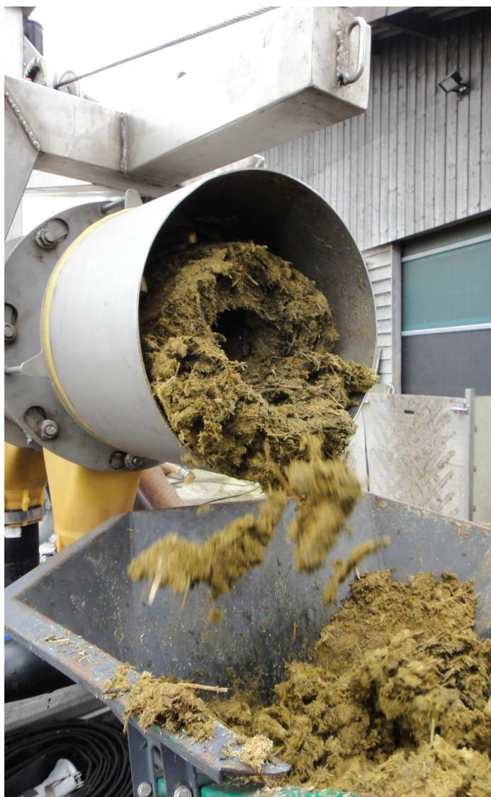
Le lisier liquide et les matières solides (photo) du lisier brut peuvent être séparés avec une vis sans fin de compression. Les vis sans fin de compression ont de faibles besoins en énergie et peuvent être utilisées dans différentes exploitations en tant qu'installations mobiles. Photo : Rapport final LEVER
