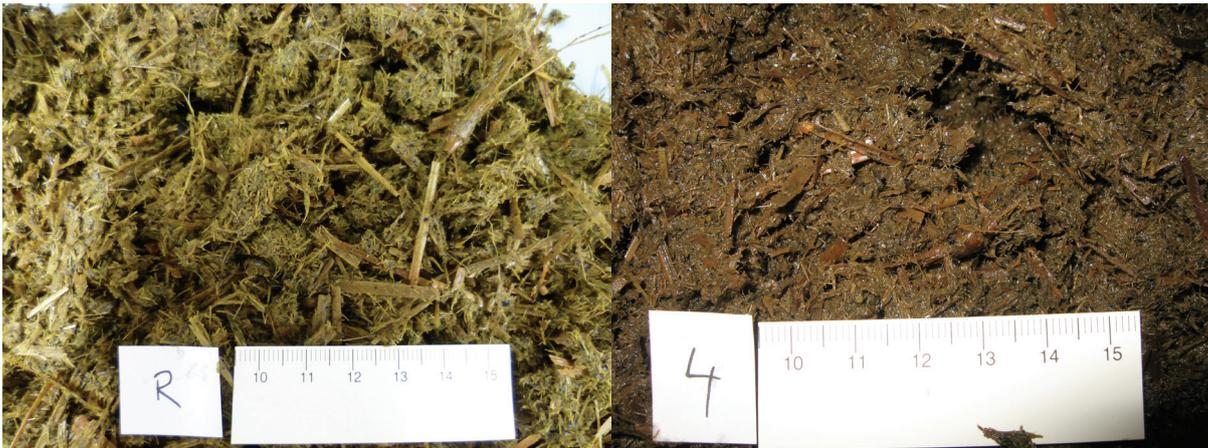
Matières solides de lisier non traitées (à gauche) et après un traitement avec le procédé d'explosion de vapeur à 150 °C et une durée de 15 minutes (à droite).
