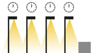
L'alimentation à deux ou plusieurs niveaux d'intensité est préprogrammée sur chaque luminaire. L'ajustement des horaires et des valeurs de consigne sont effectués directement à la fabrique.
