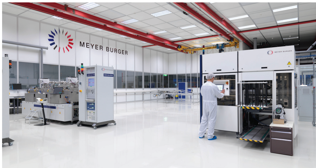
Depuis 2014, des cellules solaires à haute performance sont fabriquées dans une usine pilote de Hauterive (NE). Ces cellules combinent la technologie à couche mince et les cellules en silicium classiques. Photo : Daniel Hager/CSEM-Meyer Burger
