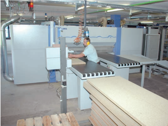
Une production orientée vers la demande des clients et fortement intégrée nécessite des installations de fabrication à commande électronique (sur la photo: découpeuse de panneaux) pour une alimentation sûre en air comprimé. (Photos: fabricant de portes Brunegg SA)
