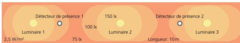
Coupe d'un couloir avec luminaires et courbes Isolux
