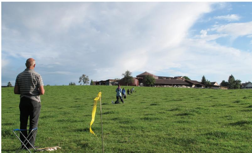
*Six personnes test à différentes distances de l'installation de biogaz note leur perception de l'odeur toute les dix secondes. Photo : Agroscope*
