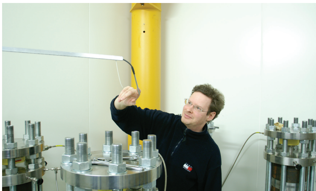
Dr. Cyril Dunant dans son laboratoire à l'EPFL. Dunant montre le capteur de température qui assure que la température ambiante de la pièce reste constante à 38° C. Photo : B. Vogel
