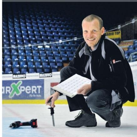
Erwin Mensink mesure l'épaisseur de glace. Il prévient ainsi des frais d'énergie inutiles. Couplé à d'autres mesures, cela permet d'économiser plus de 20 % d'énergie.
