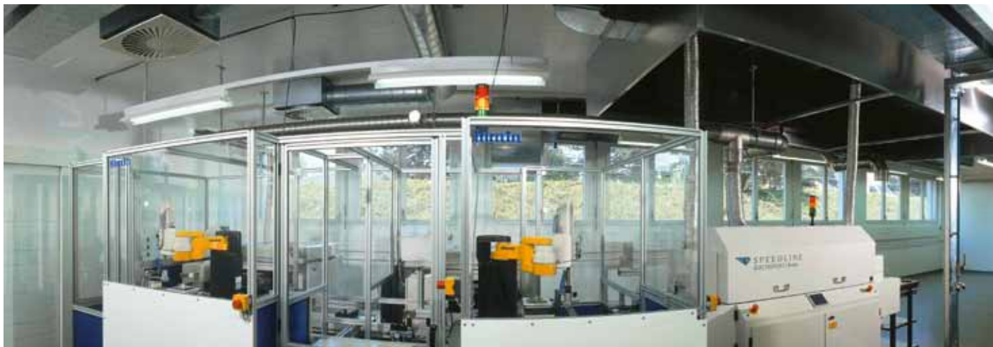
Les piles à combustible suivent un processus de fabrication semi-automatique afin que les composants en céramique soient tous de la même qualité.
