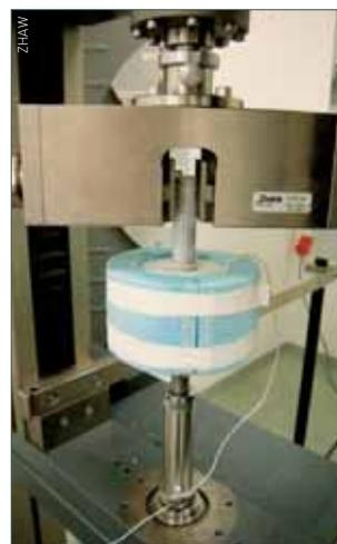
Appareil de mesure de la résistance à la traction pour le test de différents types et rugosités de surfaces : plus la topographie de la surface est rugueuse, plus forte sera l'adhérence de la glace.
