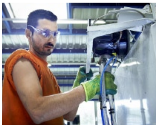
Le réfrigérant est pompé à 100% puis incinéré.
