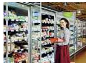
**Les portes à trois battants** ont pour avantage que les portes ouvertes ne bloquent aucun autre secteur de la vitrine. Ces portes ont cependant besoin de place à l'ouverture, donc de surface de vente.
