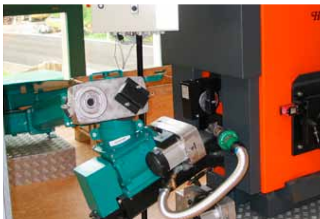
Chauffage à plaquettes (puissance 30 kW) avec dispositif anti-retour de flamme selon les prescriptions de l'AEAI.
