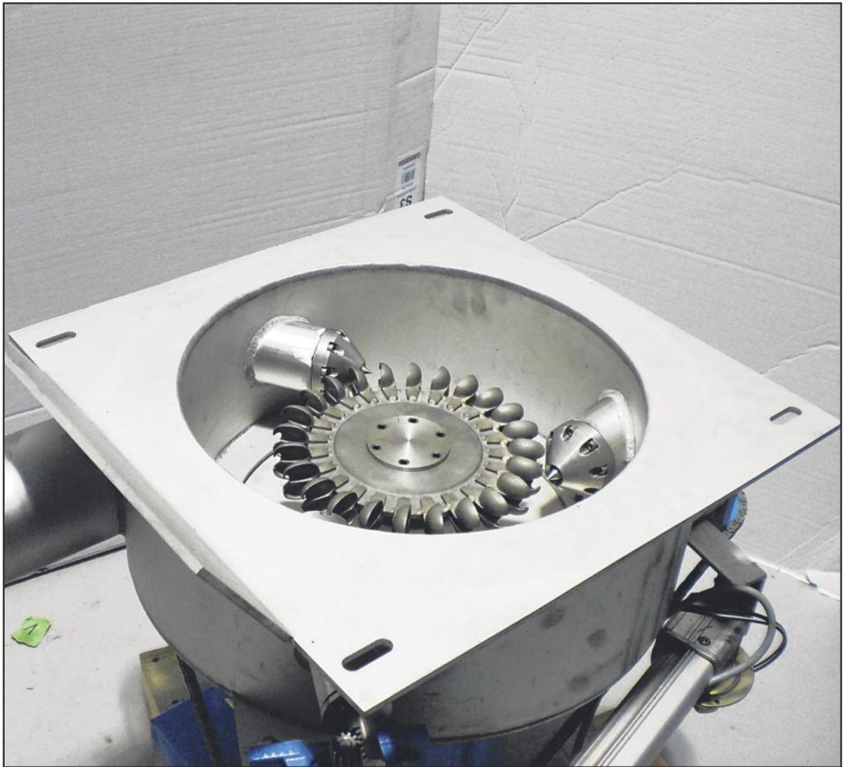
Une installation de turbinage comme celle-ci est relativement facile à installer dans un réservoir d'eau potable. FELCON AG
