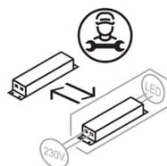
Appareillage de commande que seul un professionnel peut remplacer (le fabricant détermine qui est qualifié pour le faire).
