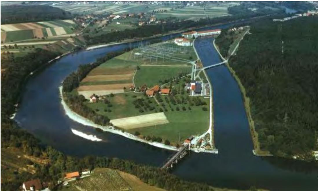
Présentation 4.9-2 : Île de Beznau en 1966, durant les travaux de construction pour la centrale nucléaire. Le sol a été retiré sur une grande surface, mais les rives n'ont pas été touchées. À l'arrière-plan, les postes et la centrale hydraulique avec les bâtiments annexes encore existants. On reconnaît divers dépôts de matériaux.
