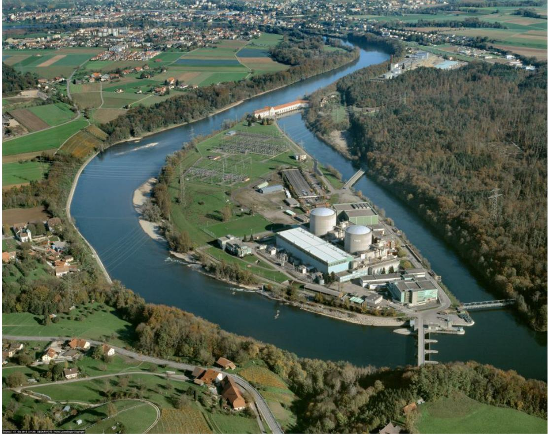
Le barrage régulateur de Beznau au premier plan et la conduite-pont Refuna à droite. Au fond, l'usine hydroélectrique à la fin du Oberwasserkanal. Les centrales KKB 1 et 2 se situent au milieu de l'image. L'entrepôt (ZWIBEZ) à la façade verte se trouve un peu au sud du pont routier.
