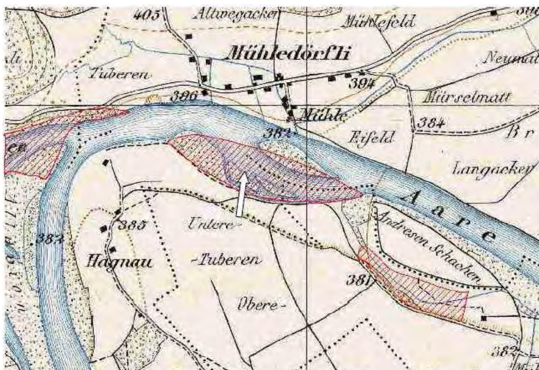
Figure 4.6-1: Extrait de la carte Siegfried de 1878 (swisstopo 1878-2007). Une comparaison avec la carte Siegfried de 1940 révèle différents remblais/comblements (hachurés). Un remblai du terrain est visible dans le secteur de l'aire principale (voir flèche).
