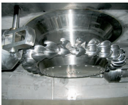
La turbine Pelton. Photo: Mhylab
