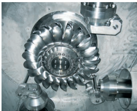
La turbine Pelton. Photo : commune de Savièse et Gasa SA
