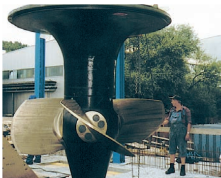
La turbine siphon. Photo : Iteco
