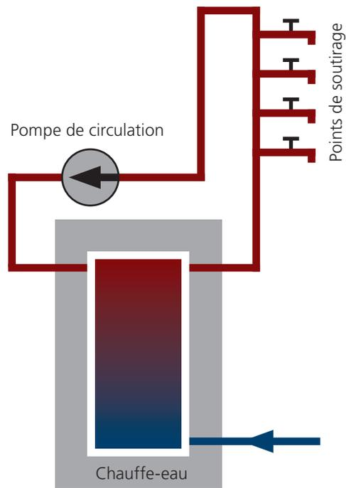
Fig. 3: Système de circulation (schéma). Source: Martina Wyss, [www.mawy.ch](http://www.mawy.ch)
