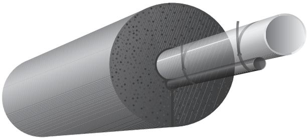
Fig. 2: Retour « tube contre tube ». Source: Martina Wyss, [www.mawy.ch](http://www.mawy.ch)
