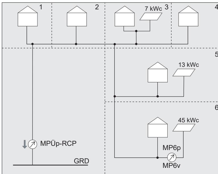
Fig. 6: Détermination des parts du surplus d'énergie du RCP sur la base de la puissance DC des installations PV impliquées
