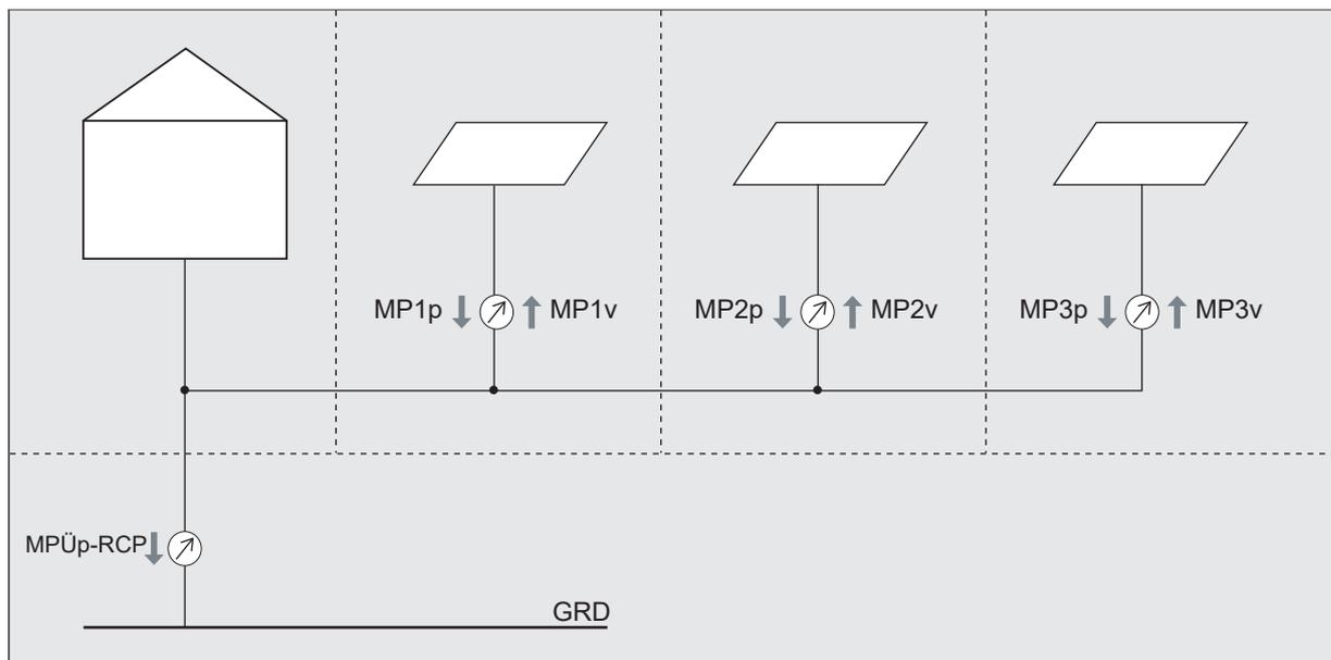
Fig. 7: Mesure des quantités de production, de besoin propre et de surplus d'énergie dans un RCP<sup>26</sup>
