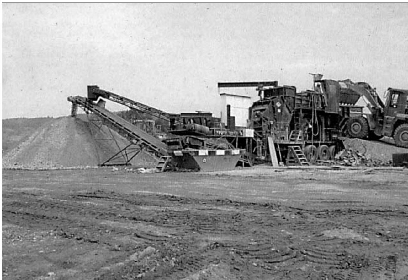
Illustration 5-1: Installation de traitement pour déchets de chantiers inertes. (Photo W. Rüegg)
