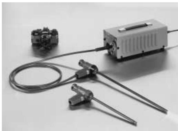
*Endoscope avec source de lumière froide*
