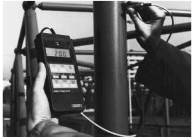
*Appareil pour la mesure de l'épaisseur de peinture selon le principe d'induction magnétique*
