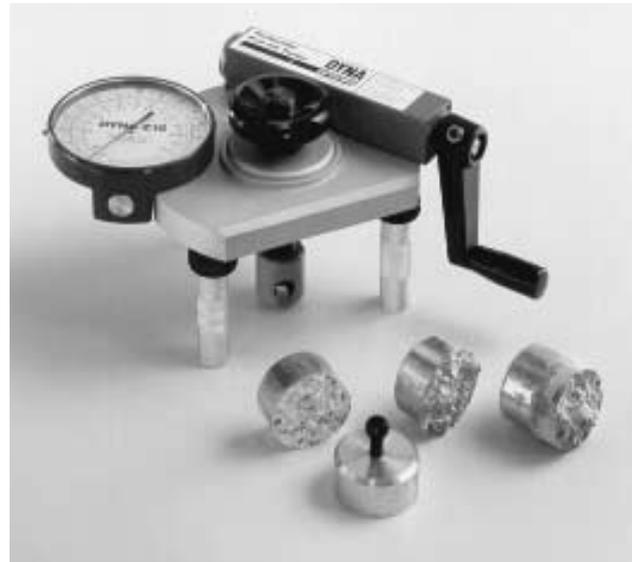
*Appareillage pour l'essai d'arrachement*
