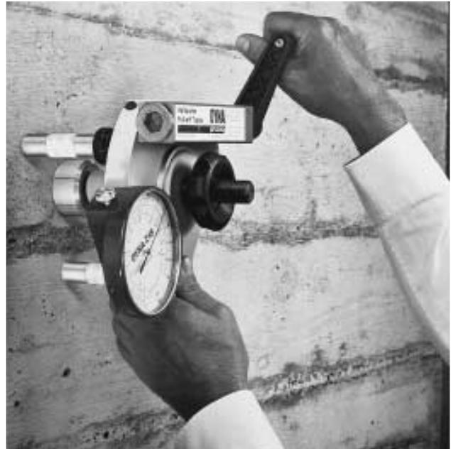
*Essai d'arrachement in situ*
