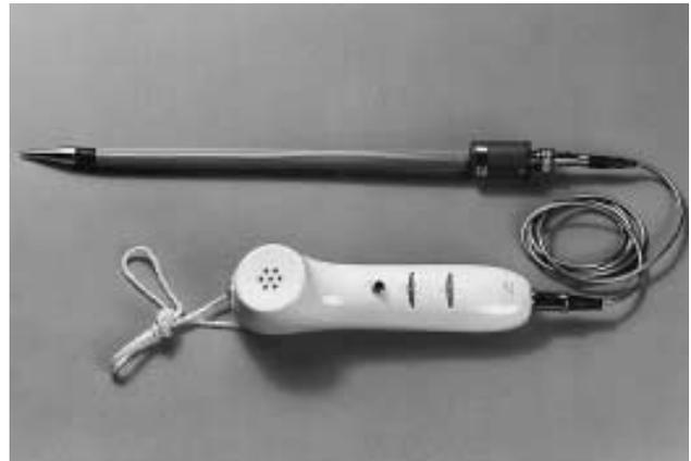
*Appareil pour la méthode acoustique de contrôle des pertes*
