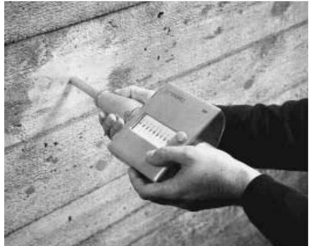
Mise en œuvre du scléromètre
