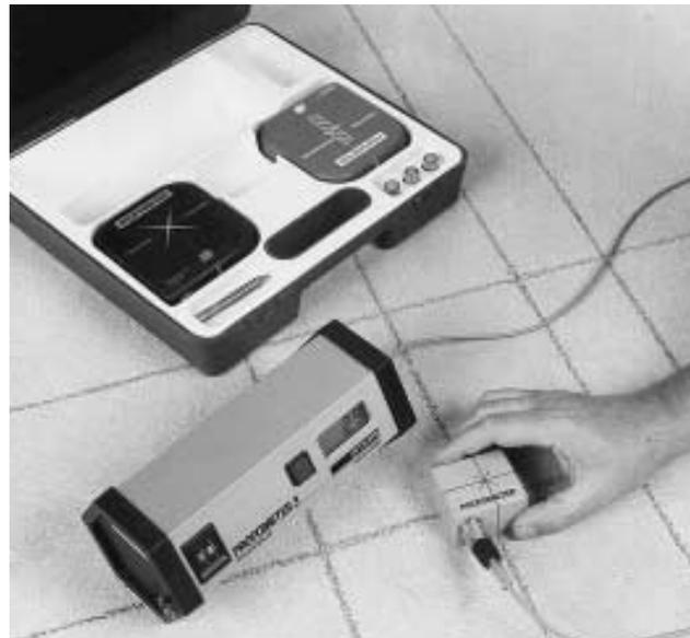
Appareil pour la mesure de l'enrobage
