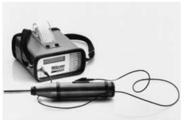
*Scléromètre, modèle avec indicateur et interprétation électronique*
