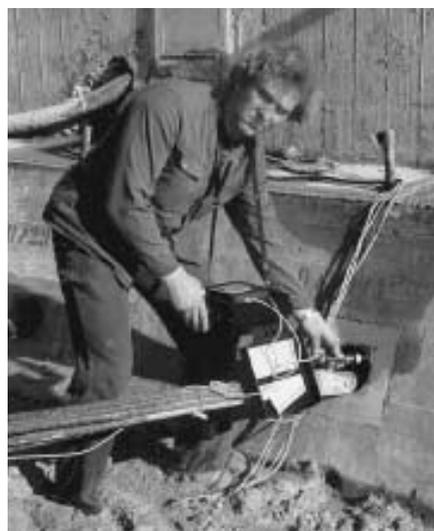
*Mesure de la résistance d'un ancrage permanent*
