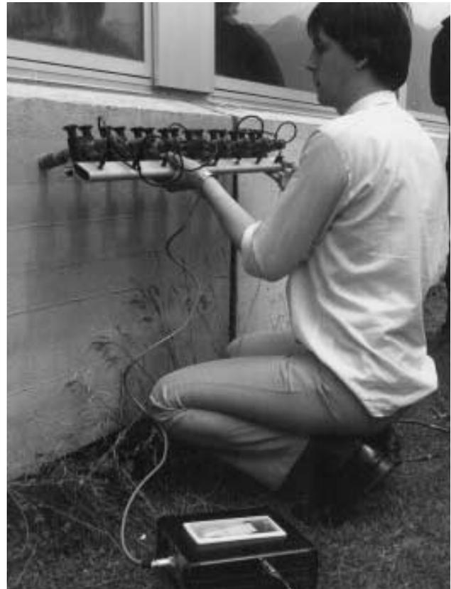
Appareillage pour la mesure de potentiel
