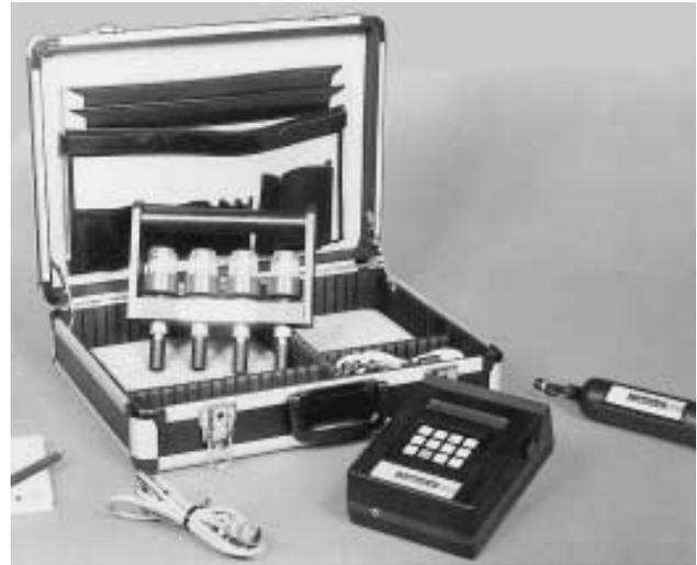
Equipement pour la mesure de la résistivité électrique
