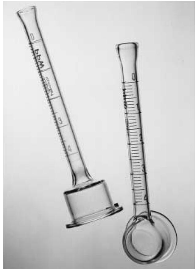
*Tubes pour l'essai d'absorption d'eau selon Karstens*
