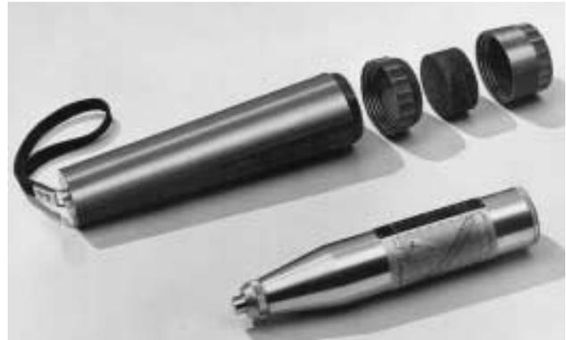
*Scléromètre, modèle simple*
