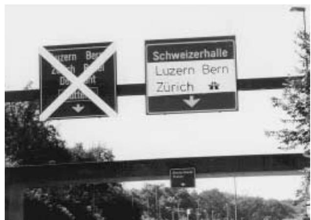
Fig. 28: Panneaux d'indication de déviation pour la modification d'itinéraire représentée à la figure 27
