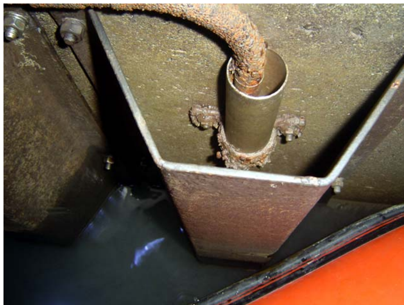
Jauge en acier inoxydable et en acier, après quelque dix ans d'exploitation.
