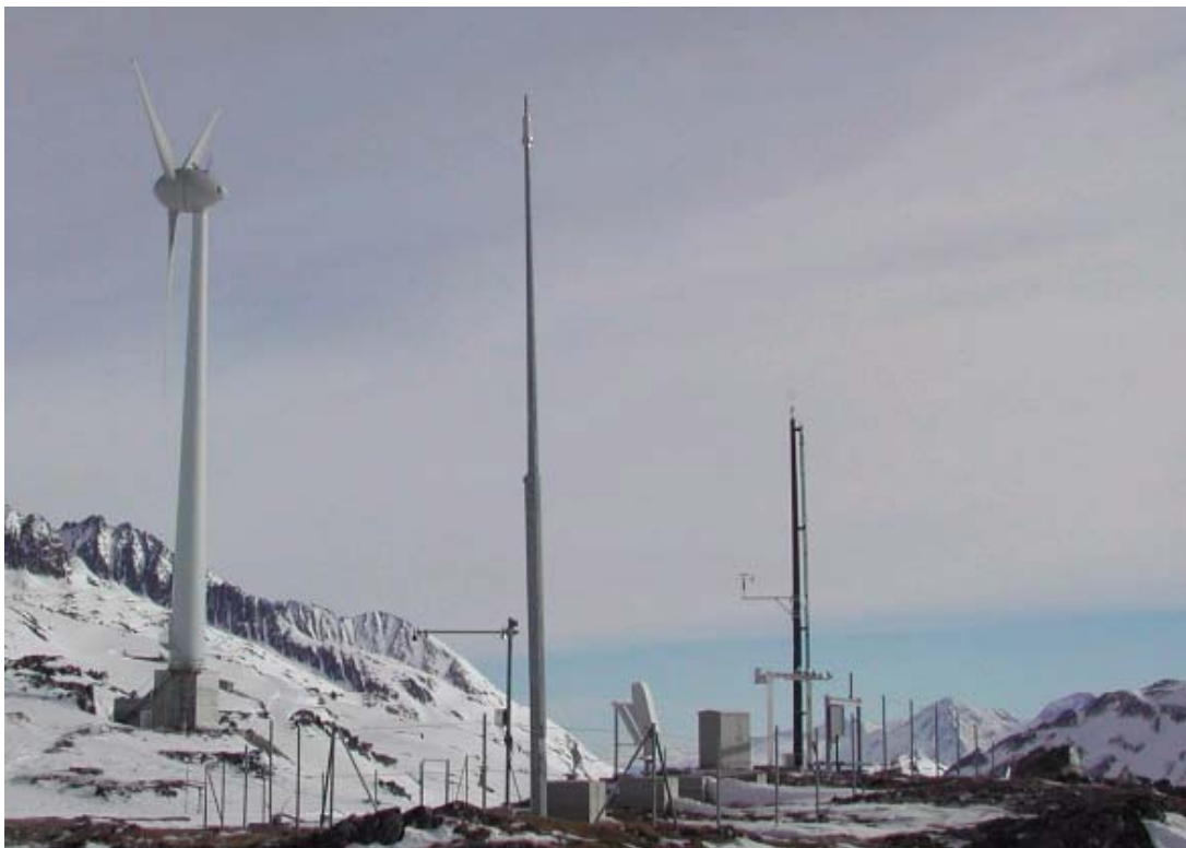
Figur 5: Aufbau der „Alpine Wind Test Site“ auf dem Gütsch, mit 600 kW Windkraftanlage und Messstation der MeteoSchweiz für Eisdetektoren – ein neuer Fokus der Schweizerischen Windenergieentwicklung
