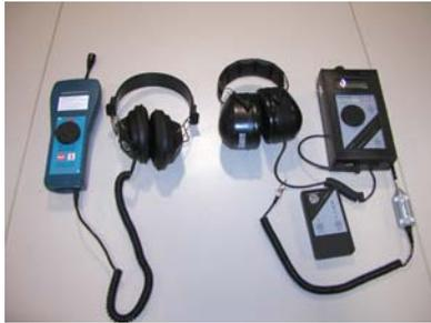
Figure 5 : Appareils de détection aux ultrasons des fuites d'air comprimé
