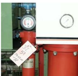
Figure 6 : Marquage d'une fuite au niveau d'un filtre
