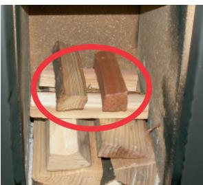
Dans des **foyers étrois**, vous disposez les bûches avec la section transversale vers l'avant.
