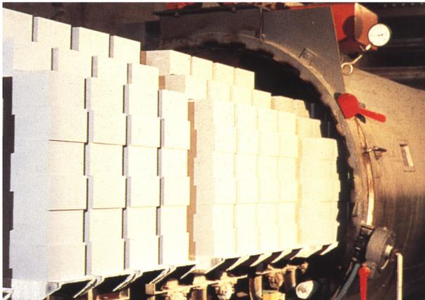
Fig. 10: Fabrication de briques silico- calcaires dans un autoclave
