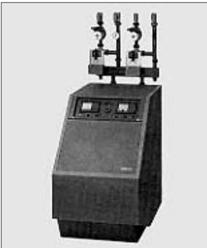
Figure 3.9: Unité de chauffage avec raccordement et circulateur [H6].
