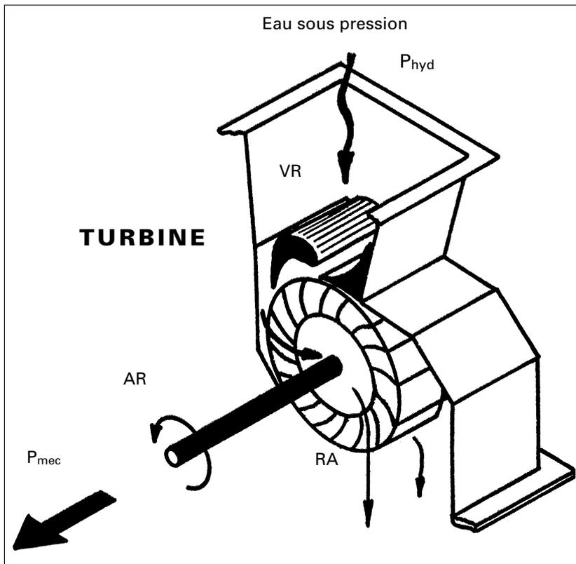
*Machine alimentée en eau sous pression, qui met en mouvement une roue à aubes et produit de la force, ou puissance mécanique, par l'intermédiaire d'un arbre en rotation*
