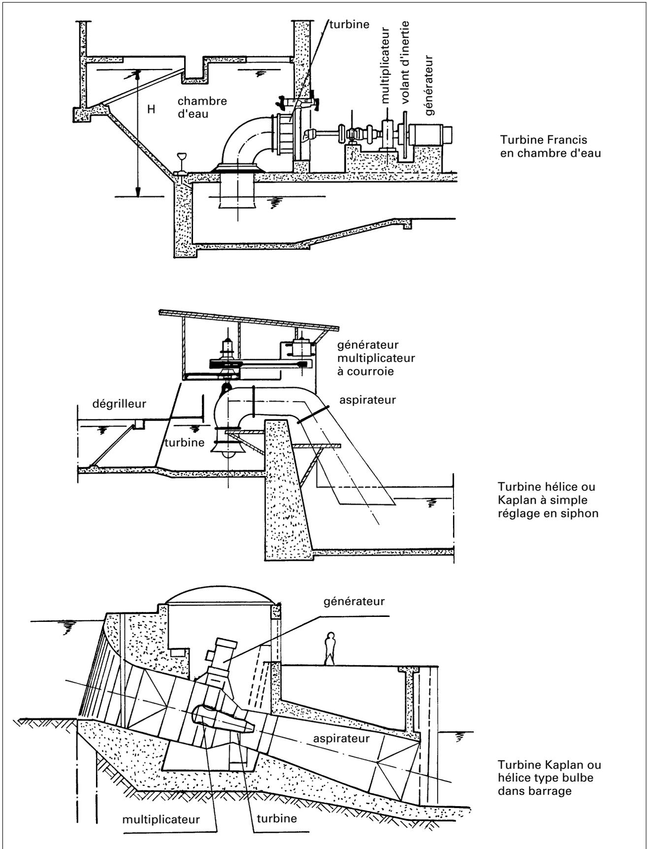
Figure 4.1.4.c Exemples de turbines basse chute et de leur implantation
