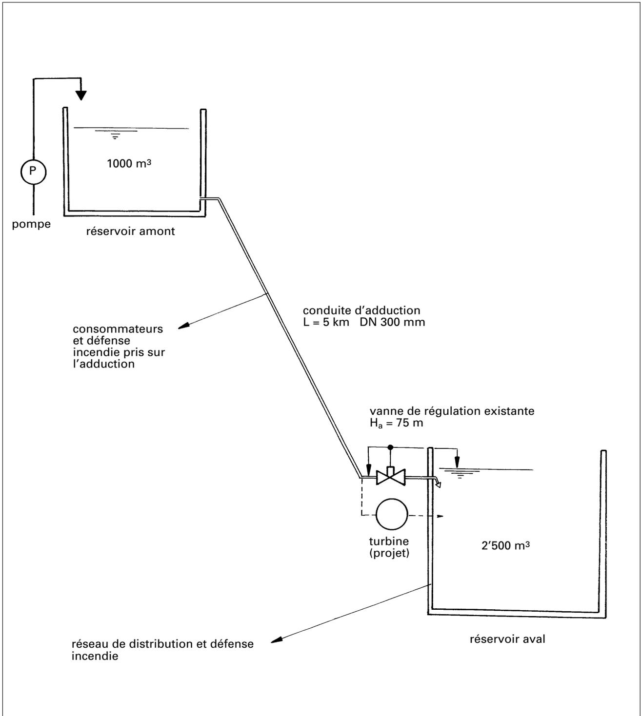
Figure 5.2.2: Turbinage de l'eau potable entre deux réservoirs
