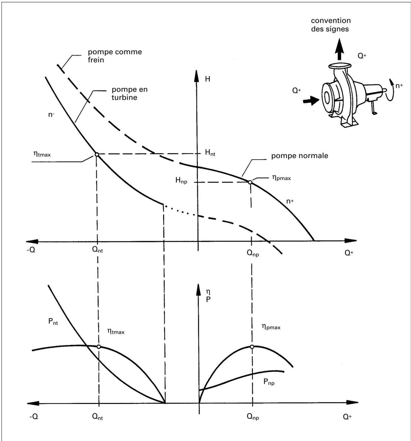
Figure 3.5: Courbes caractéristiques complètes d'une pompe à vitesse de rotation constante
