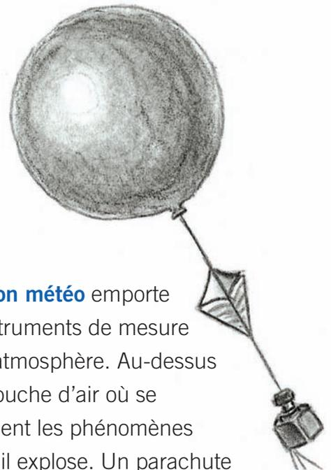
Le **ballon météo** emporte des instruments de mesure dans l'atmosphère. Au-dessus de la couche d'air où se produisent les phénomènes météo, il explose. Un parachute s'ouvre et les instruments de mesure redescendent sur terre.
