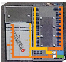
Figure 13 : Ventilation halle 1997 et 2002 droite
