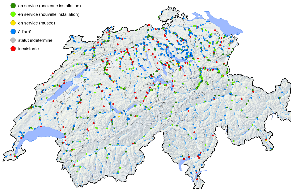
Figure 3 : Carte synoptique des installations hydroélectriques historiques de la Suisse (au total 1486), y compris les installations qui n'existent plus (pour ces dernières, l'emplacement approximatif indiqué dans la statistique de 1914 a été utilisé) 12
