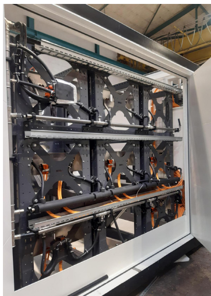
Photo du premier prototype de batterie tampon, composé de jusqu'à huit batteries connectées en série. Photo : rapport final de l'OFEN Mega-Charger
