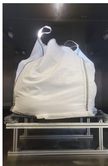
Lors des essais de résistance mécanique réalisés à l'institut de recherche OFI à Vienne, les modules photovoltaïques ont été chargés de sacs de sable pendant une heure. Les essais ont été réalisés dans une chambre climatique où des températures pouvant atteindre -40°C. Photo : OFI/Gassner, également utilisé dans l'article « Enhanced mechanical load testing of photovoltaic modules for cold and snowy climates » dans EES Solar (RSC Publishing)
