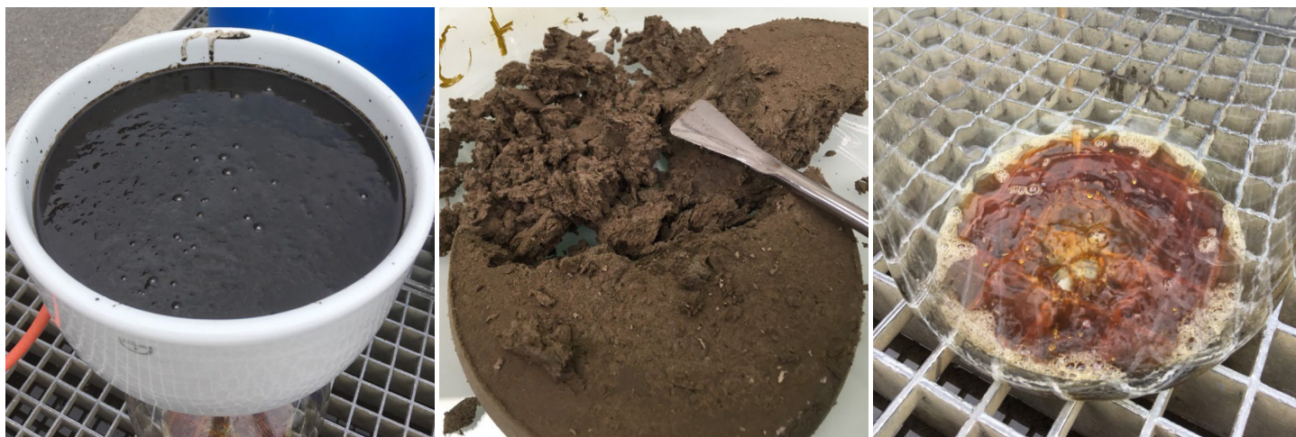
Lors de l'étape de carbonisation hydrothermique, le mélange charbon-eau (à gauche) génère du charbon HTC (au centre) et de l'eau de traitement (à droite). Photos : rapport final VARESI
