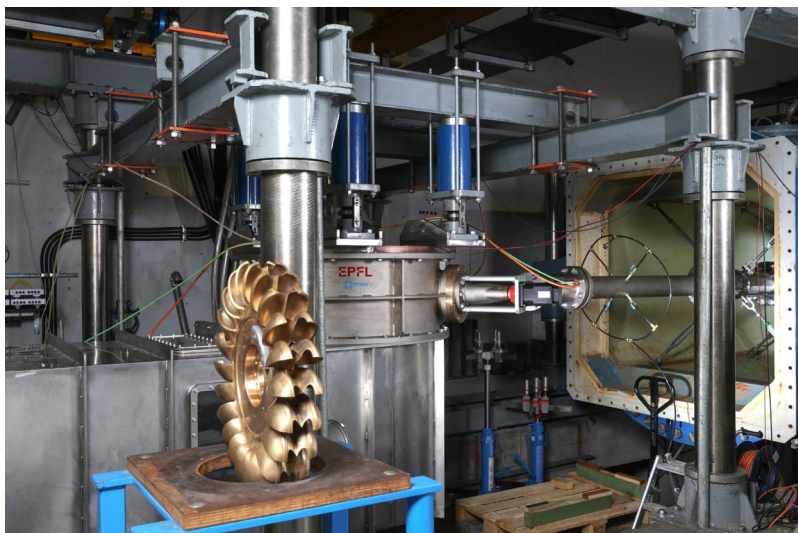
Vue de la turbine Pelton utilisée pour la production d'électricité (source : rapport final HydroLEAP, 2025).
