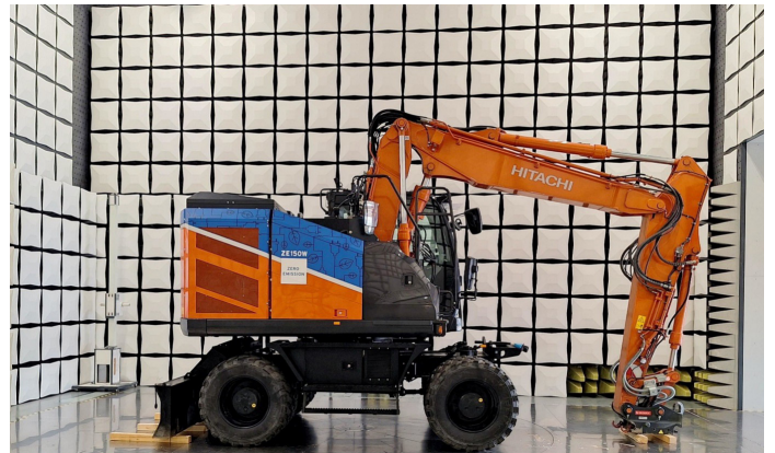
La pelle électrique ZE150W dans le laboratoire d'essais de compatibilité électromagnétique (CEM). Photo : SUNCAR
