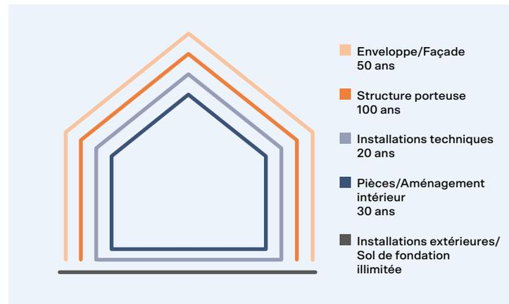
Figure 6.1: Couches de durabilité (selon le DGNB, d'après le modèle des «shearing layers» de Stewart Brand)
